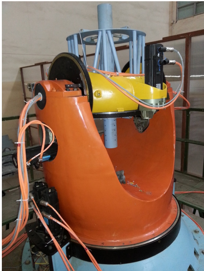
Рисунок 2. ОПУ ЗПШК-1 с имитатором нагрузки (Модернизировано ООО "Сервотехника", http://www.servotechnica.ru ).
