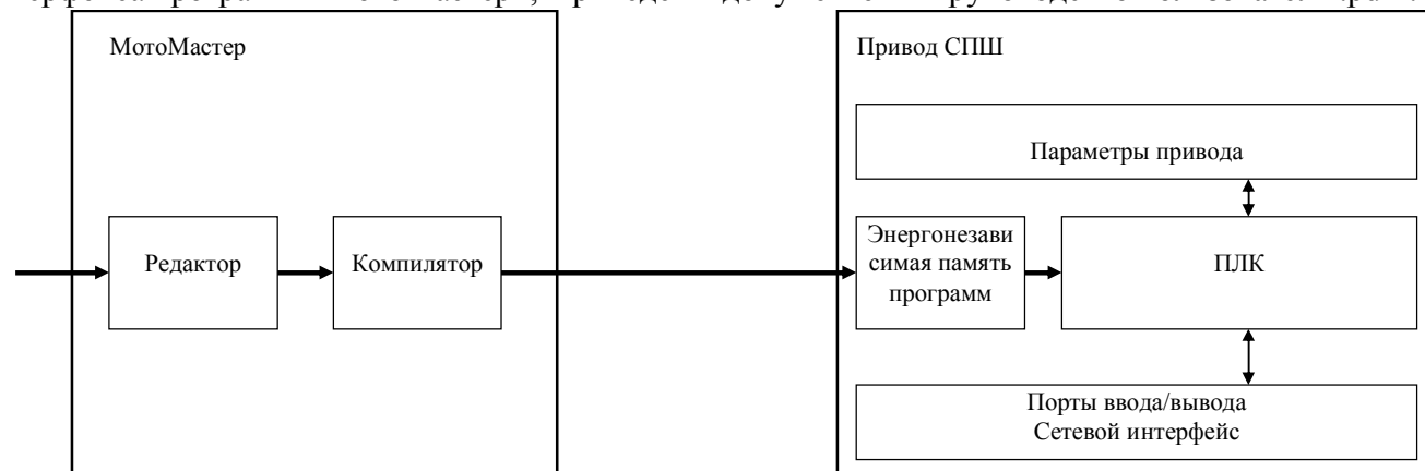
Рис. 1. Взаимодействие МотоМастер и привода в процессе программирования ПЛК.
