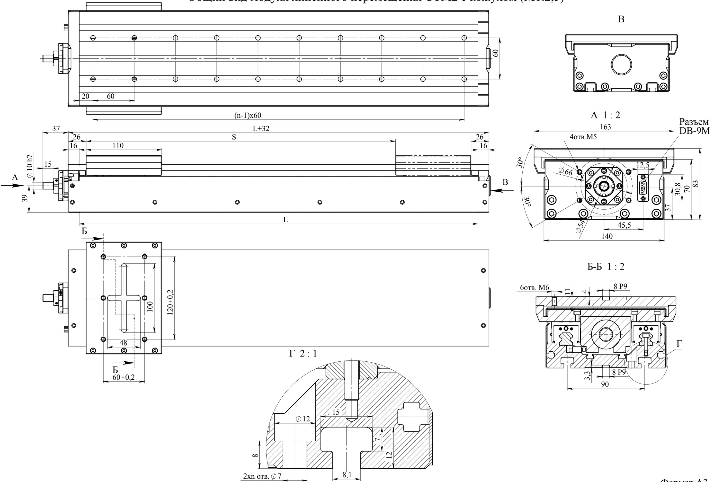
Общий вид модуля линейного перемещения СТМУ2 с кожухом (М1:2,5)
