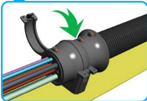
Assemble RKS completely with bolts and nuts. RKC를 사용하여 RKS를 그림처럼 고정시킨다.
