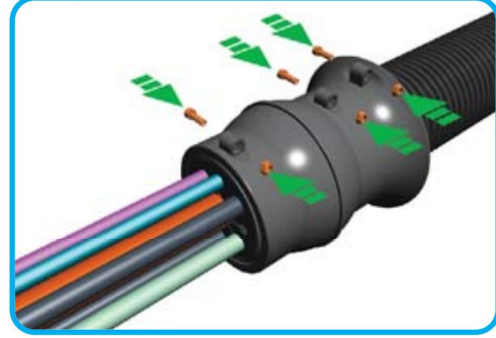
Assemble RKS completely with bolts and nuts. RKS를 볼트와 너트를 이용하여 고정시킨다.
