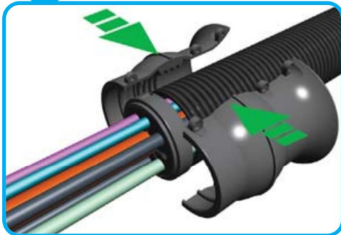
Assemble RKS with RKSC. RKS를 RKSC와 튜브를 감싸도록 좌우로 결합한다.
