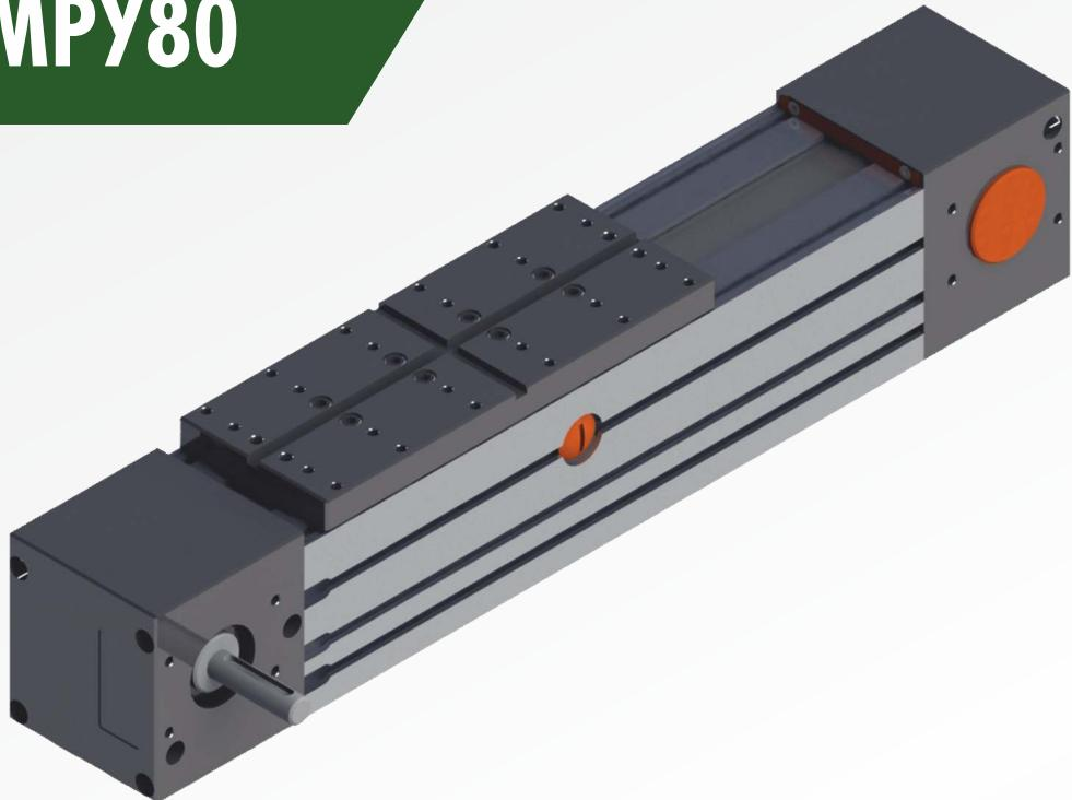
Линейка модулей MP80/MPU80 с механической передачей движения через полиуретановый ремень предоставляет возможность решить практически любые задачи по перемещению грузов весом до 50 кг на расстояние до 5600 мм со скоростью до 3 м/с.
