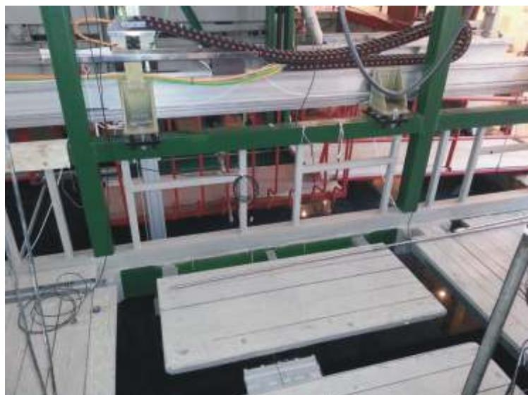
Еще в советское время в институте для проведения гидроакустических исследований была создана лаборатория, оснащенная бассейнами. Во время эксперимента исследуемые элементы (гидроакустические преобразователи) перемещаются под водой в заданные позиции, далее при помощи специальных анализаторов проводятся исследования.
