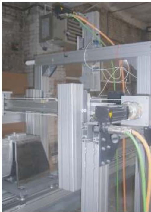
Установка обеспечивает контроль всей поверхности лонжерона за исключением 200 мм от конца, 1300 мм от комлевой части и 20 мм по носку лонжерона. Эти участки проверяют ручным контактным способом кроме 20 мм от носка. Максимальные габаритные размеры лонжерона - 8000 x 100 x 220 мм.
