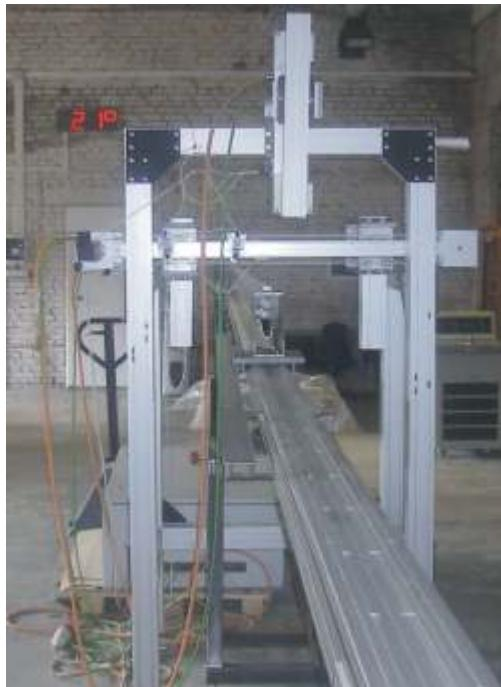
необходимо было тщательным образом «пройтись» по всей поверхности лонжерона, не пропустить ни один участок. Увеличение объема выпускаемой продукции сподвигло предприятие-заказчика предпринять меры для повышения производительности изготовления лопастей. Таким образом, возникла необходимость в автоматизации процесса контроля.
