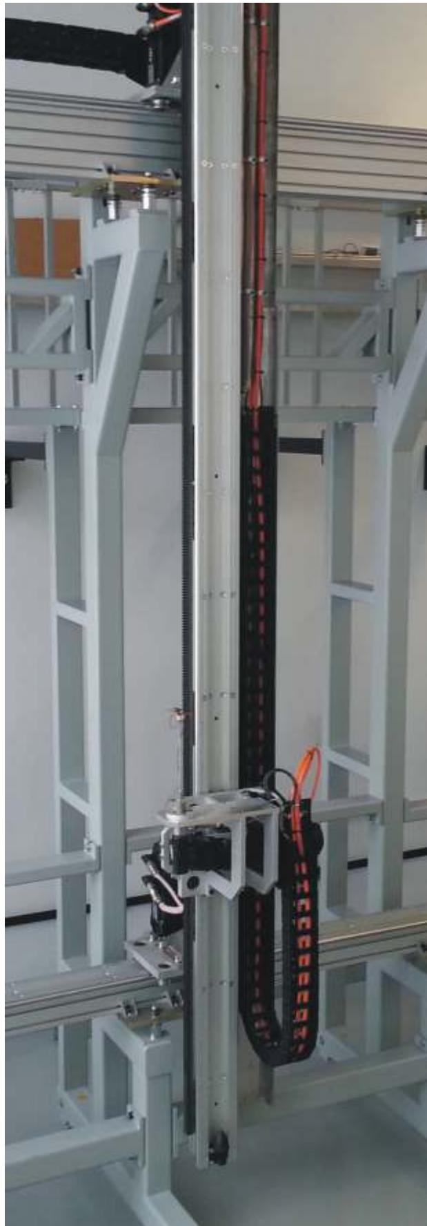
На координатах X и Z в качестве ограничителей хода установлены индуктивные выключатели (по два на каждую ось), а для выхода в “ноль” установлены индуктивные выключатели исходного положения (по одному на каждую ось). На оси А установлен единственный индуктивный выключатель выполняющей одновременно обе функции: ограничителя хода и исходного положения.
