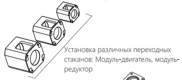
Установка различных переходных стаканов: Модуль-двигатель, модуль-редуктор
