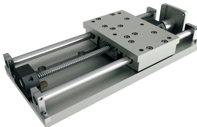
Модуль серии СТМЛ-1 состоит из основания (несущий силовой элемент) и закрепленных на основании цилиндрических направляющих качения. На подшипниковых опорах установлен винт, крутящий момент к которому передается от двигателя через компенсирующую муфту. За счёт вращения винта происходит перемещение каретки модуля, которая в свою очередь служит базовой платформой для крепления на ней всевозможных изделий и механизмов.
