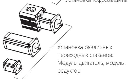
Установка различных переходных стаканов: Модуль-двигатель, модуль-редуктор
