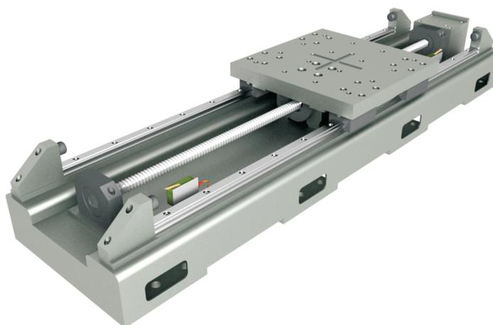
Модуль линейного перемещения является исполнительным механизмом, передающим воздействие от управляющего устройства на объект управления, и предназначается для осуществления точного и плавного перемещения устанавливаемых на него объектов по прямой траектории.
