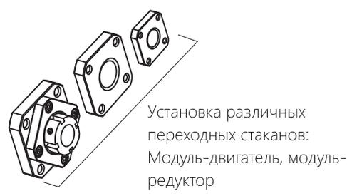
Установка различных переходных стаканов: Модуль-двигатель, модуль-редуктор
