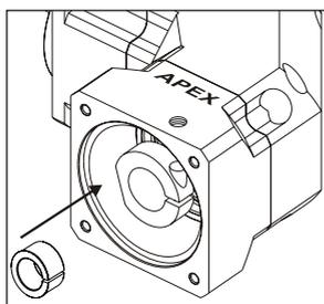
Проверьте размер диаметра вала и при необходимости вставьте расширительную втулку.
