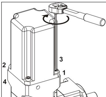
Закрутите монтажные винты в порядке, указанном на рисунке. При помощи специального гаечного ключа закрутите винты до моментов затяжки, указанных в таблице № 1.
