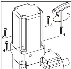
Производите монтаж в вертикальном положении. Закрутите монтажные винты (вместе с шайбами) в порядке, указанном на рисунке, при помощи ключа до значений, составляющих 5 % от моментов, указанных в таблице № 1.
