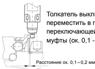
Толкатель выключателя следует переместить в положение как можно ближе к переключающей втулке предохранительной муфты (ок. 0,1 - 0,2 мм).
