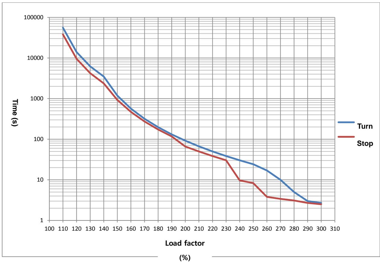
■ Servo Drive Overload Graph (750W, 1kW)
