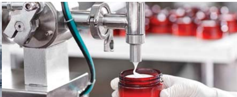
Производство косметики — установка для розлива кремов
