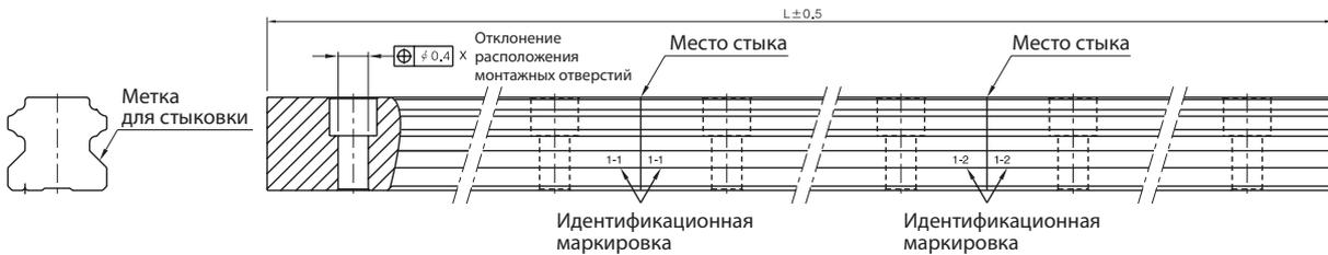
Рис. 3. Правила стыковки рельсов
