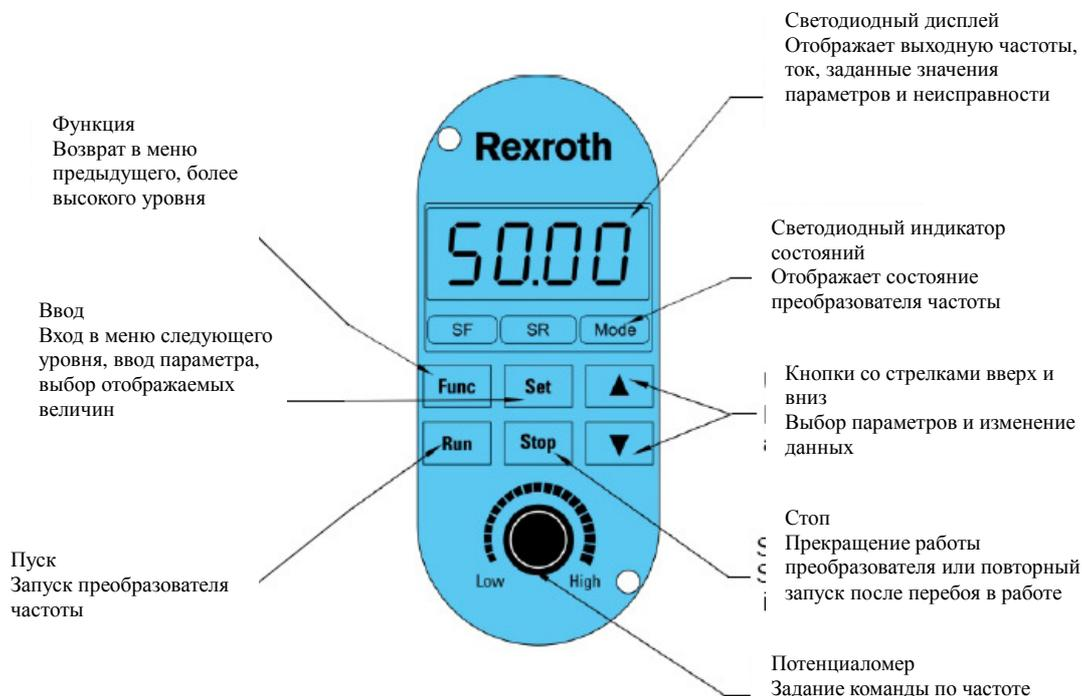
Примечание: 0,75 – 7,5 кВт преобразователь имеет потенциометр в качестве стандартной конфигурации, а 11 - 110 кВт преобразователи имеют потенциометр в качестве дополнительного оборудования).
