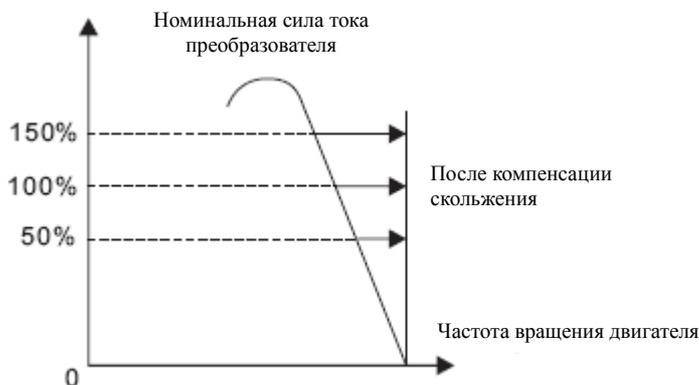
Примечание: При использовании компенсации частоты скольжения отключите управление снижением [H37], установив параметр [H37]=0,00.
