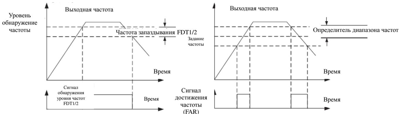
Если выходная частота находится в диапазоне Заданная частота ±[E15], то активируется цифровой выход “Сигнала достижения частоты (FAR)”.
