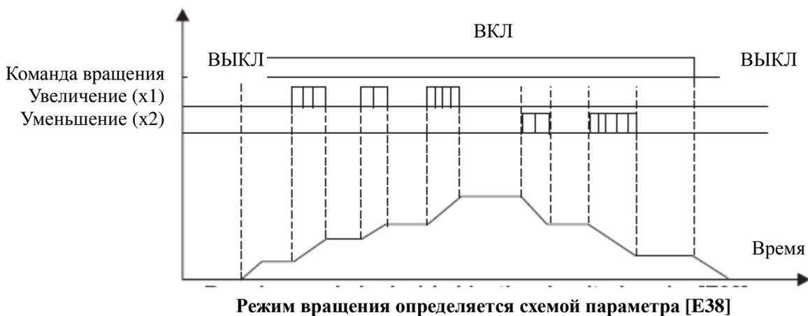
[b00]=2: Внешнее через клеммы управления (в том числе многоскоростные) при активной кнопке Stop (Стоп) (связанные настройки: [E38] и параметры группы P)
