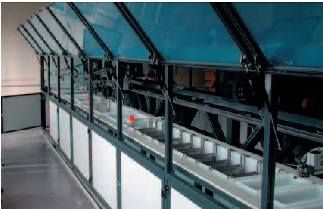
Автоматическая линия нанесения покрытий
