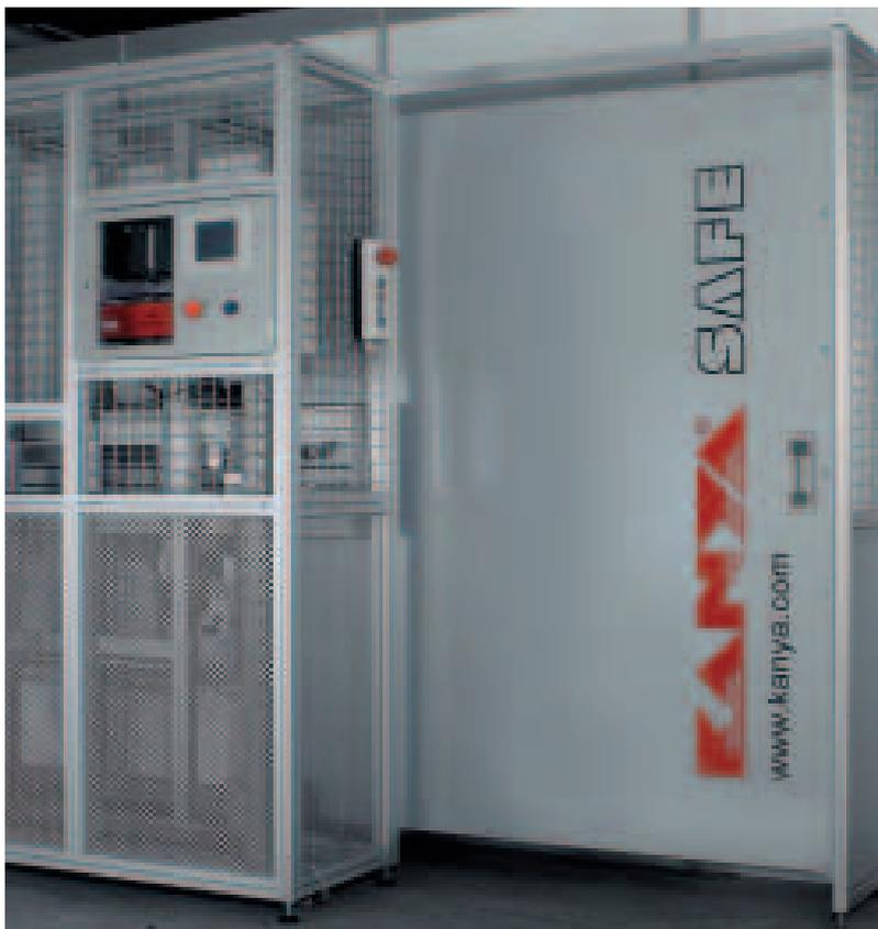
Защитное ограждение с автоматической дверью
