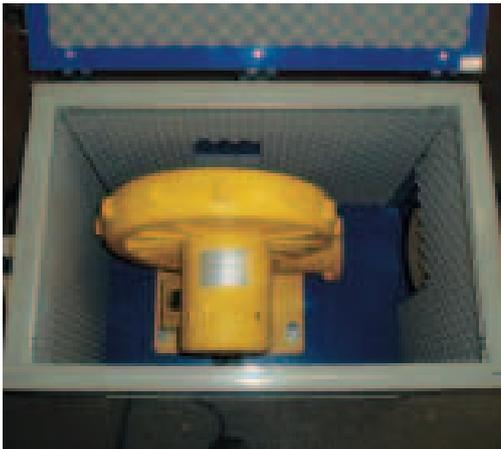
Звукоизоляция для вентилятора
